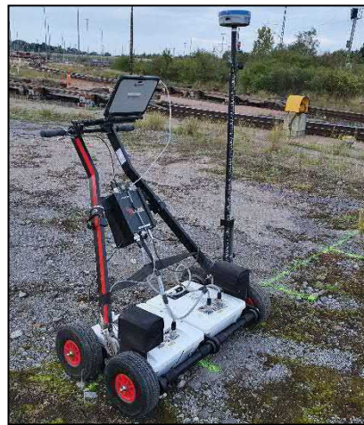
Abbildung 2: IDS RIS MF Hi-Mod Bodenradar mit Spurbreite 1,0 m
